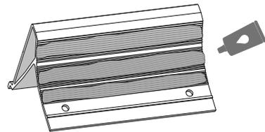
**ES** **Importante:** es fundamental usar el adhesivo SIKA 252 para fijar el soporte (los soportes).
